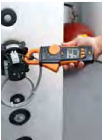
Medición de tensión en un acumulador térmico con el testo 770.
