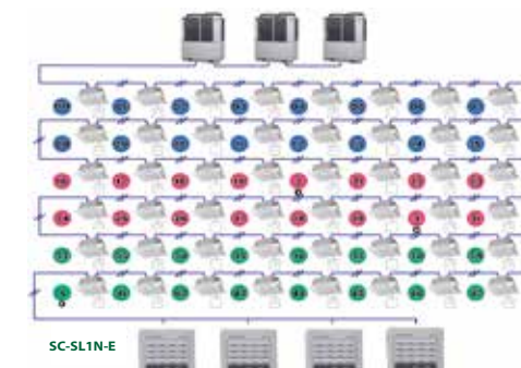
Ejemplo del control realizado por una consola central SC-SL1N-E
