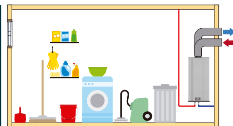
Conducción entrada/ salida
