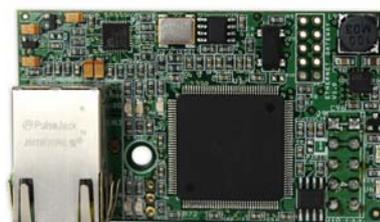
Esta pasarela permite integrar con sistemas de gestión de edificios. Es un dispositivo Plug&Play para los sistemas Airzone permitiendo controlar los parámetros del sistema de control de climatización. Compatible con BACnet (ANSI/ASHRAE-135) y BACnet/IP (ISO 16484-5).
