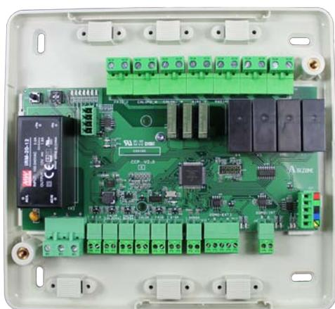
El módulo de control de producción permite controlar el equipo de producción y la red de distribución mediante los relés incorporados.
