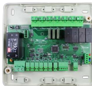
Con este módulo podrás activar las cajas de ventilación o recuperadores de calor y regular su funcionamiento.
