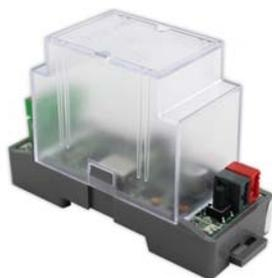
Esta pasarela permite integrar el control de la climatización de las distintas soluciones Airzone en sistemas KNX de forma simple. La pasarela KNX está disponible en ETS®.
