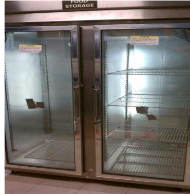
Figura 3. Foto del armario congelador de R-404A utilizado en el ensayo experimental
