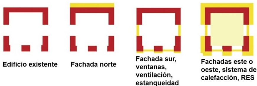
Figura 2. Rehabilitación fachada a fachada
