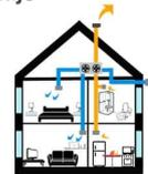
Se produce un intercambio de temperatura entre los flujos de aire.
