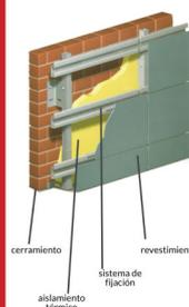
**¿Qué es?** Disponen de una cámara de aire continua entre la capa de aislamiento y el revestimiento exterior por la que circula el aire. El revestimiento está formado por placas de piedra natural, metálico, resinas, vidrio, etc.
