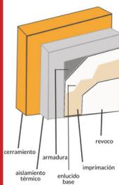
**¿Qué es?** Planchas rígidas de material aislante adheridas al muro, mediante adhesivos y fijación mecánica, protegidas por un revestimiento de una o varias capas y con un revoco de acabado o un aplacado fijado al muro de ladrillo, cerámica o piedra.
