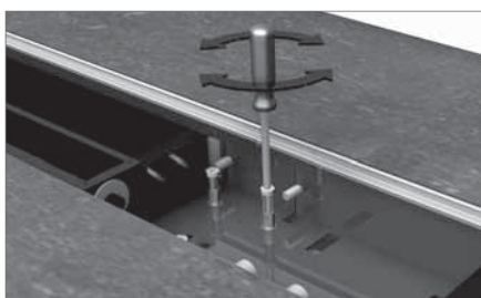
Doble ajuste de altura mediante los anclajes del canal exterior y por el ajuste fino con las tuercas en el canal interior (ajustable de 6.2 a 8 cm).
